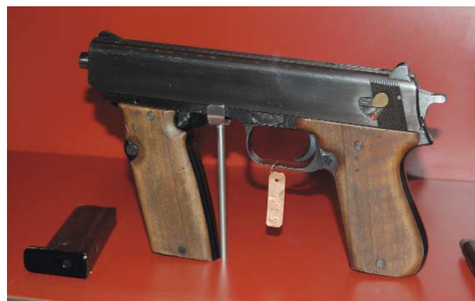
Автоматический пистолет «IX съезд СЕПГ». Калибр 9 мм, длина ствола 180 мм, начальная скорость пули 365 м/с, скорострельность техническая – 800 выстр./мин., практическая – 70-80 выстр./мин., масса 2,24 кг, вместимость магазина 9 или 13 патронов. Зульский завод выпустил только 14 таких пистолетов
